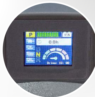
Das digitale Display zeigt übersichtlich Ladestand, Fehlercode, Betriebszeit und Fahrmodus an.
